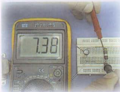
Figura 7.69. Medición del voltaje de salida del rectificador sin filtro
